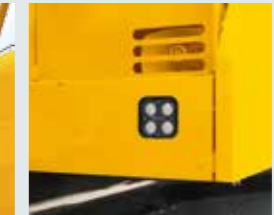
▲LED作業灯 (左マシシルーム)
